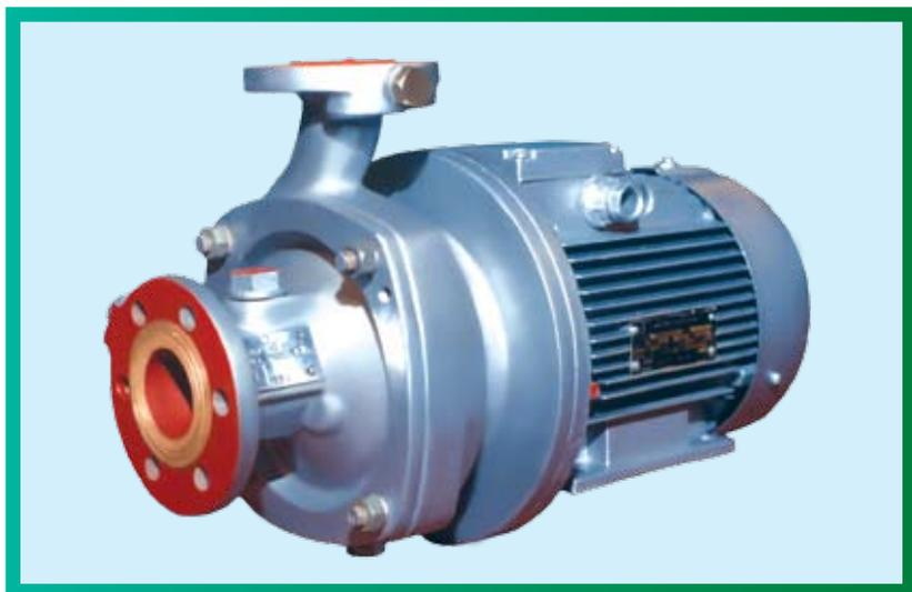
Электронасосы НЦКГ предназначены для подачи конденсата температурой 90°C, плотностью 1000 кг/м<sup>3</sup>, дистиллята температурой 70°C и плотностью 1000 кг/м<sup>3</sup> и рассола (или морской воды) температурой от -40 до 70°C, плотностью не более 1060 кг/м<sup>3</sup>. Насос горизонтальный, консольный, одноступенчатый, центробежный.
