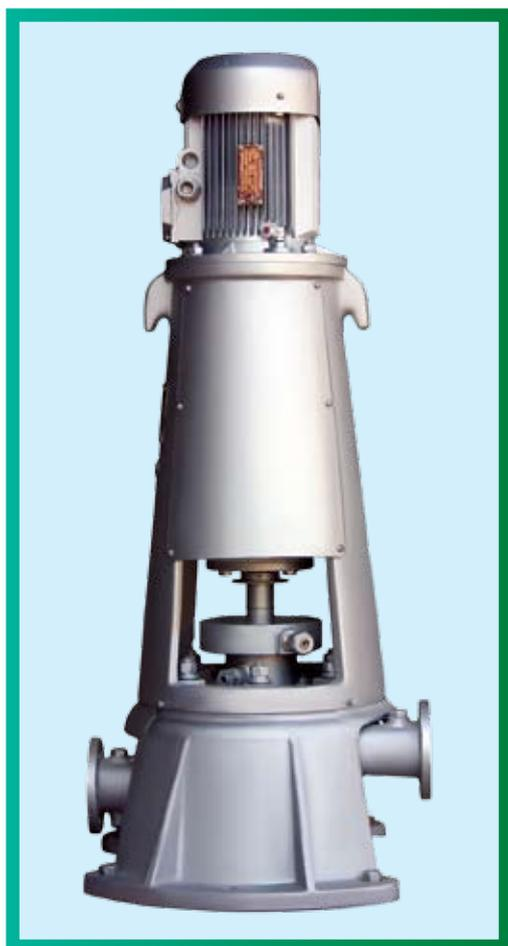
Вертикальный одноступенчатый центробежный электронасосный агрегат ЭКН 10/40 служит для обеспечения принудительной циркуляции воды температурой до 160°C в утилизационных (паровых) котлах судовых систем. Может быть использован для перекачивания воды и в других системах при обеспечении подпора на всасывании и подаче на уплотнительный сальник запирающей (охлаждающей) воды температурой 65° С и давлением 13 бар.
