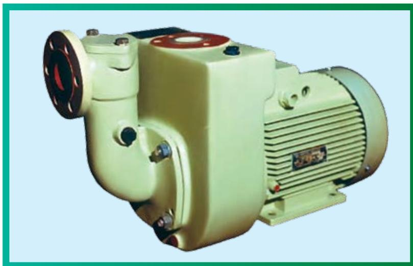
Электронасосы ЦВС служат для перекачивания морской(соленой), пресной и питьевой воды температурой до 70°C. Насосы допускают перекачивание воды с примесью нефтепродуктов и механических примесей размером не более 1 мм. Электронасосы обладают самовсасывающей способностью, что позволяет устанавливать их на высоте 7 м над поверхностью жидкости.
