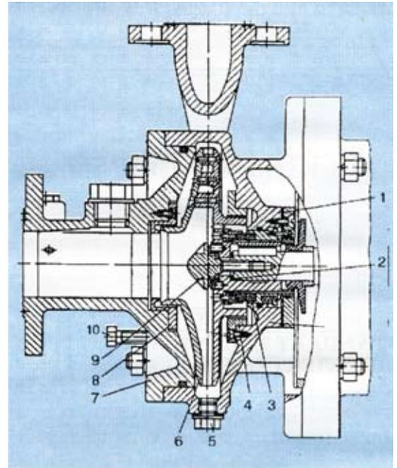
1 - Корпус; 2 - Шайба; 3 - Торцовое уплотнение; 4,8 - Кольцо уплотнительное; 5 - Пробка; 6 - Колесо рабочее; 7 - Крышка; 9 - Болт специальный; 10 - Винт отжимной
