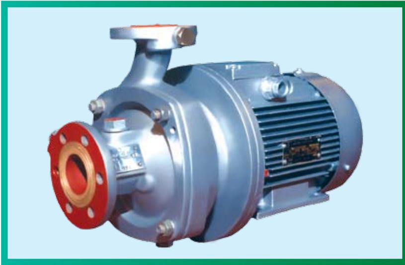
Электронасосы НЦКГ предназначены для подачи конденсата температурой 90°C, плотностью 1000 кг/м<sup>3</sup>, дистиллята температурой 70°C и плотностью 1000 кг/м<sup>3</sup> и рассола (или морской воды) температурой от -40 до 70°C, плотностью не более 1060 кг/м<sup>3</sup>. Насос горизонтальный, консольный, одноступенчатый, центробежный.
