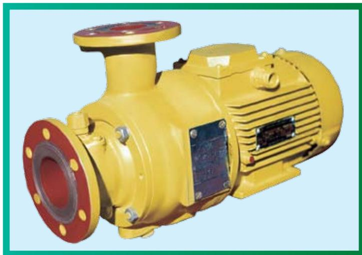
Электронасос предназначен для перекачивания хозяйственно-бытовых и сточно-фекальных вод температурой до 55°C плотностью 1050 кг/м<sup>3</sup>, кислотностью от 6 до 9 рН, содержащих абразивные частицы в объеме не более 0,25%
