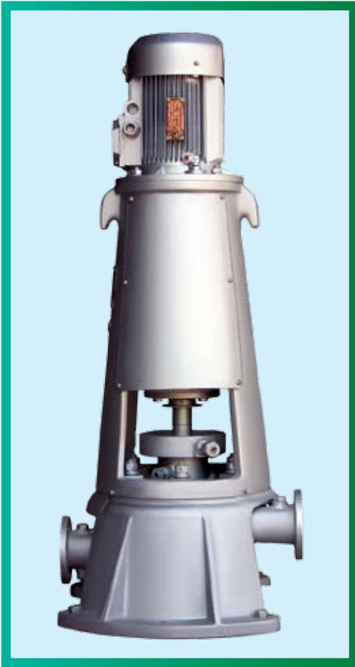
Вертикальный одноступенчатый центробежный электронасосный агрегат ЭКН 10/40 служит для обеспечения принудительной циркуляции воды температурой до 160°C в утилизационных (паровых) котлах судовых систем. Может быть использован для перекачивания воды и в других системах при обеспечении подпора на всасывании и подаче на уплотнительный сальник запирающей (охлаждающей) воды температурой 65° С и давлением 13 бар.
