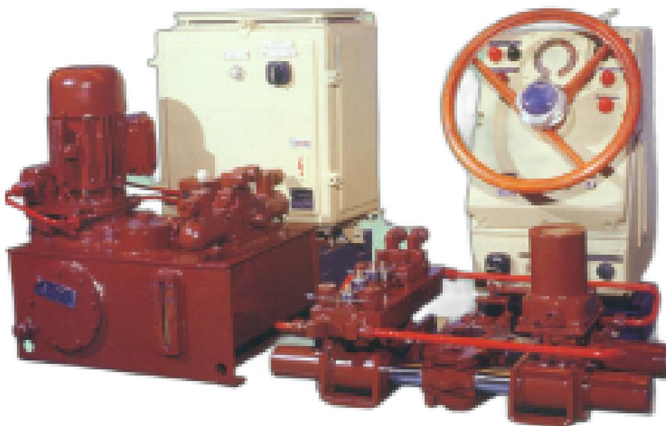
Машины рулевые РГМ предназначены для перекладки рулей и поставляются в составе рулевого устройства катеров и других малотоннажных судов ограниченного района плавания. Удовлетворяют требованиям Регистра РФ.
