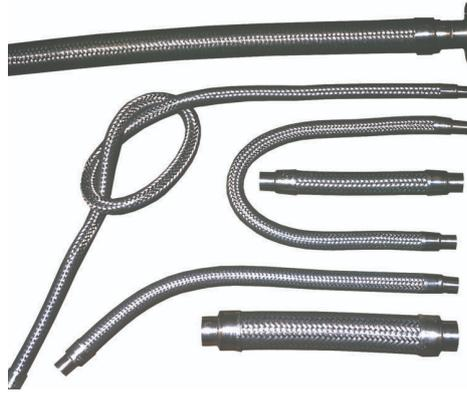
Гибкие металлические шланги предназначены для компенсации относительных угловых перемещений и двигов от тепловых расширений соединяемых трубопроводов. Могут быть использованы для транспортировки рабочих продуктов со скоростями: жидкость — 10 м/с, газ — 40 м/с.
